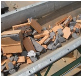
Der Ziegelbruch gelangt über ein Förderband zum Backenbrecher und anschliessend zum Wasserbad.
