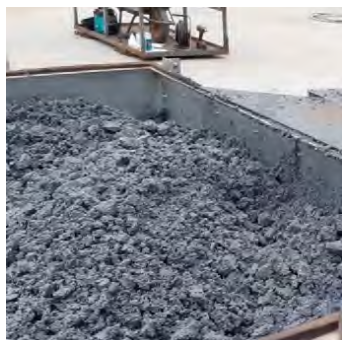
Das AdPor® wird nach der Aufbereitung der nächsten Ziegelproduktion zugeführt.
