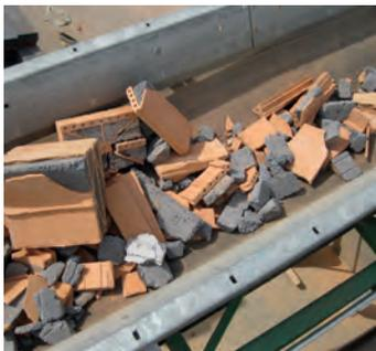
Der Ziegelbruch gelangt über ein Förderband zum Backenbrecher und anschließend zum Wasserbad.
