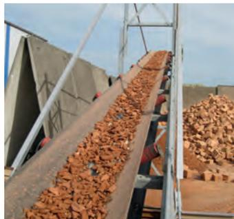
Der sortenreine Ziegelbruch kann einer weiteren Verwendung zugeführt werden.
