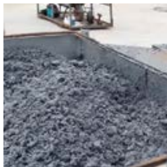
Das Polystyrol wird nach der Aufbereitung der nächsten Ziegelproduktion zugeführt.
