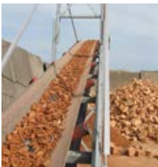
Der sortenreine Ziegelbruch kann einer weiteren Verwendung zugeführt werden.
